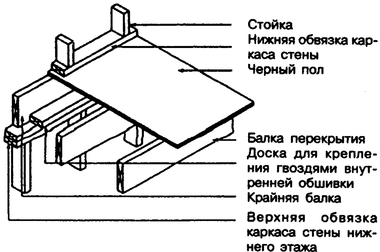
Рисунок 7-4 — Деталь установки доски для крепления внутренней обшивки
